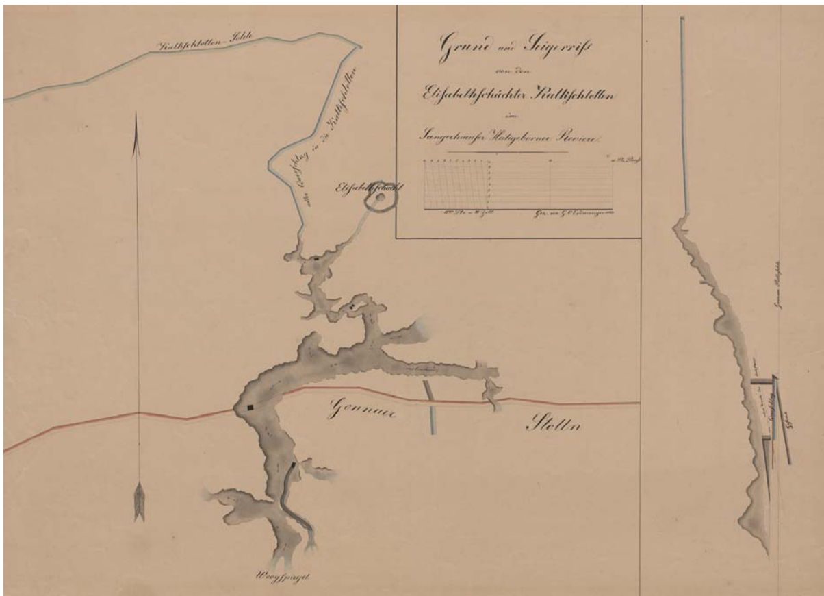
Riss der Elisabethschächter Schlotte, von Gustav Otto Erdmenger 1847 als Bergschülerarbeit angefertigt. Dargestellt ist die Situation vor dem Trockenfallen der südlichen Abschnitte und vor dem Versatz um den Blindschacht herum.
